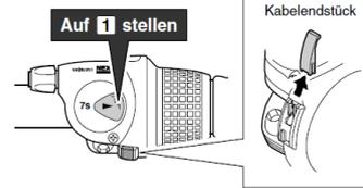
2. Drehen Sie die Kabelabdeckung, so daß die Kabeleinstellschraube um ungefähr 7 bis 8 mm vorsteht. Lösen Sie danach die Abdeckungsschraube und nehmen Sie die Anzeigenabdeckung ab.
