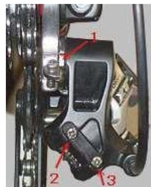
Schaltwerk in folgende Position bringen: kleinstes Ritzel am Rad und mittleres Kettenblatt an Kurbel. Schaltzug aus Zugklemmschraube lösen.
