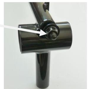
Beim City 7 befindet sich am Steuerrohr eine Vorrichtung mit der der Zahnriemen gespannt wird. Der Zahnriemen soll immer leicht unter Spannung stehen, um ein Überspringen zu verhindern.
