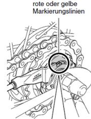
Die roten oder die gelben Markierungslinien der Schalteinheit befinden sich an zwei Stellen. Verwenden Sie die besser sichtbaren Linien.
