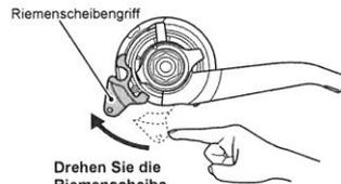
10. Das Kabel an der Riemenscheibe anbringen, sodass die Innenkabelbefestigungsmutter nach außen gerichtet ist (zum Rahmenende hin) und schieben Sie dann die flache Seite der Innenkabelunterlegscheibe in die offene Seite der Riemenscheibe.
